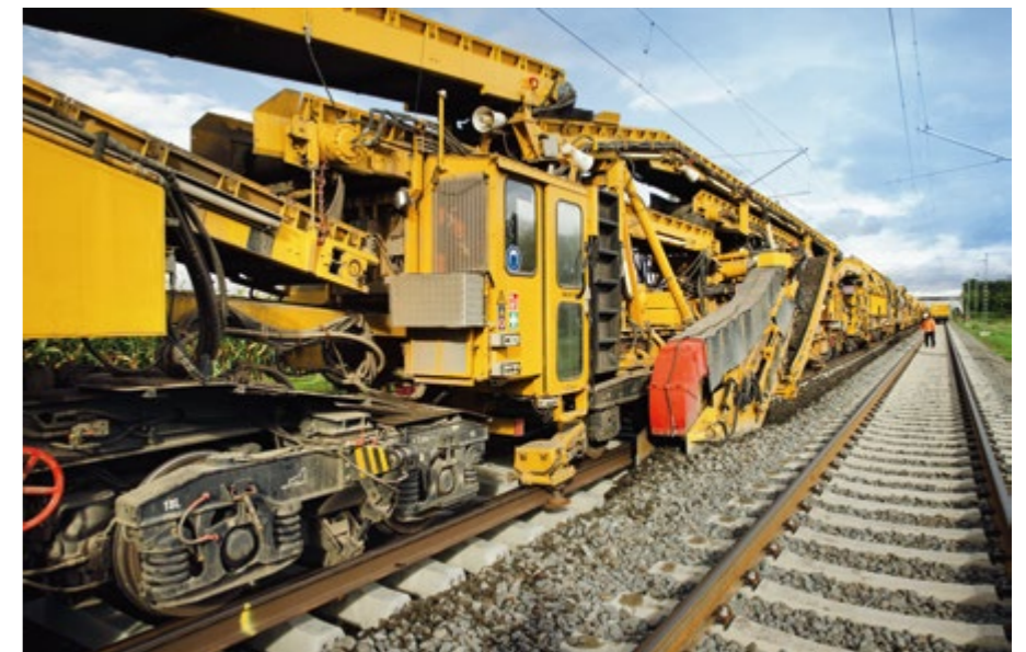
Strojní linka pro rekonstrukci kolejového roštu RU 800 S
