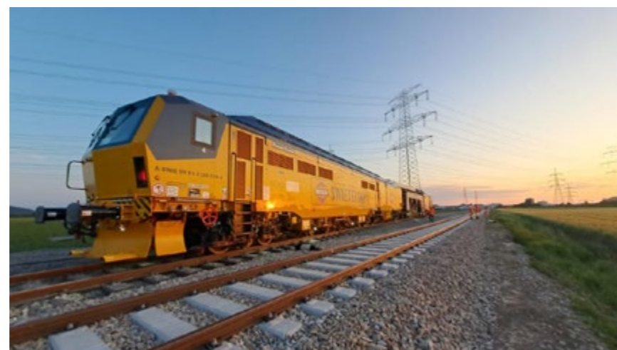
Automatická strojní podběječka Unimat 09-8x4-4S Dynamic, Rakousko
